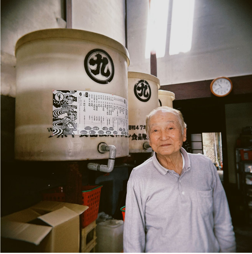
△ Gujō Hachiman | Yüz yılı aşkın süredir kendi miso ve soya soslarını üreten Yamani Shōten, üretim sürecinde Gujō'nun doğal kaynak sularını kullanıyor. Dükkan sahibinin arkasında görünen tanklarda Gujō usulü miso fermente ediliyor; süreç sırasında süzülen sıvı ise yöreye özgü ji-damari soya sosuna dönüşüyor.
